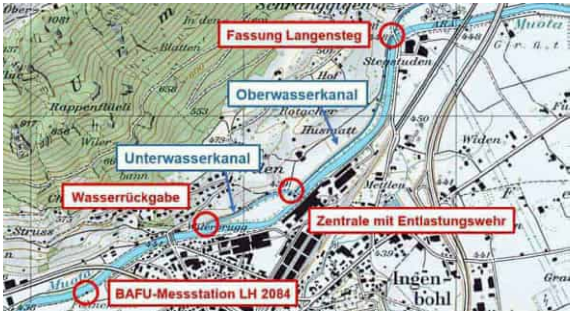
Abbildung 10: Situationsübersicht des Kleinwasserkraftwerkes Brunnen, ergänzte Abbildung aus [22]
