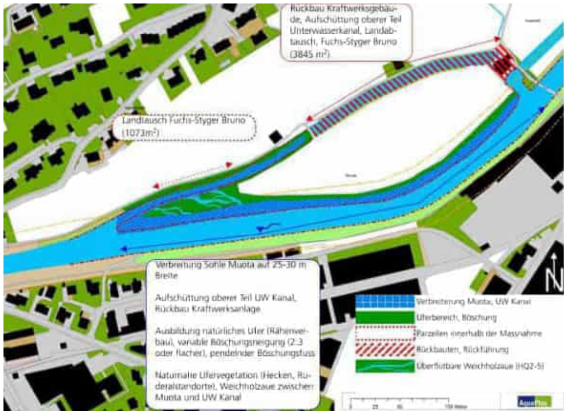
Abbildung 30: Skizze Ersatz- und Ausgleichsmassnahmen, Neukonzessionierung Muotakraftwerke [42]
