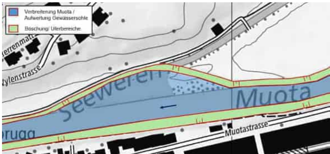
Abbildung 34: Skizze aus Variantenstudium Vorprojekt, Variante A4 lokale Aufweitung bis auf Niveau Sohle
