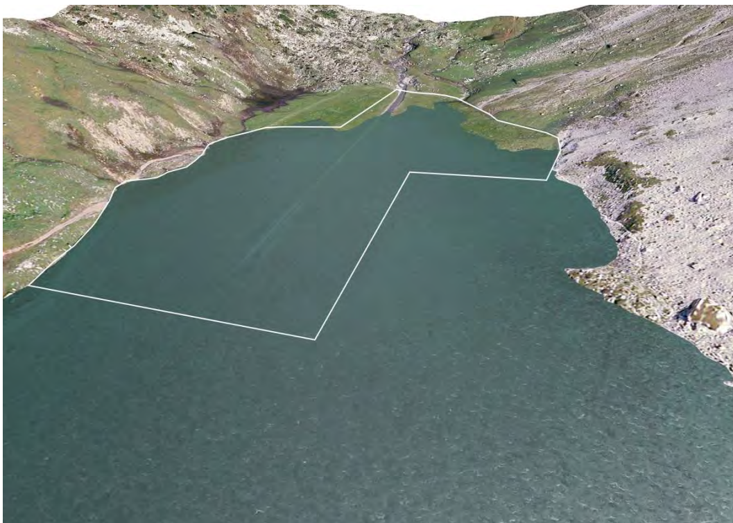
Abbildung 6-12 Visualisierung der Situation nach der Sanierung der Teilabdichtung des Glattalpsees mit angedeutetem Materialabbauperimeter (weisse Linie).
