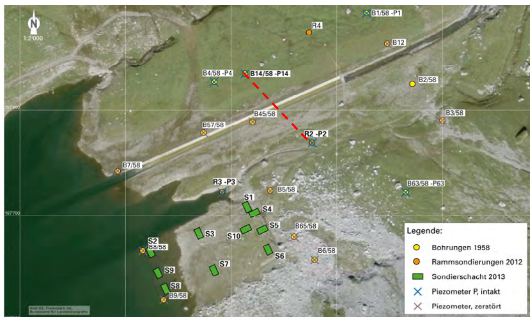
Abbildung 5-7 Orthofoto Steinibachdelta mit Lage der Sondierungen und Piezometer (Dr. von Moss AG, Anhang [1], bearbeitet von AFRY)
