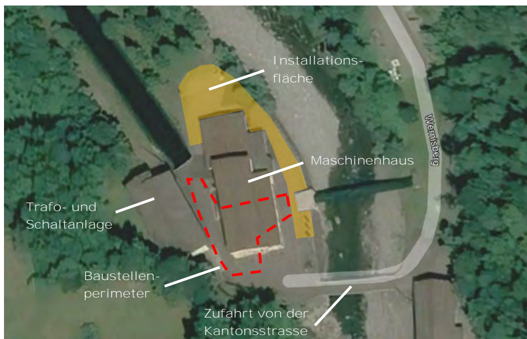
Abbildung 4-1 Situation des Kraftwerks Wernisberg mit angedeuteter Installationsfläche, Baustellenperimeter und Zufahrtsstrasse (Google Earth, 2019-07).
