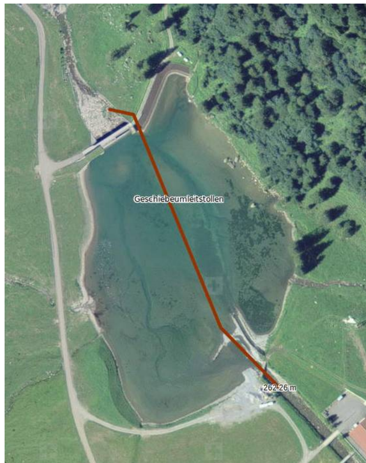
Abbildung 17: Mögliche Linienführung für Geschiebeumleitstollen
