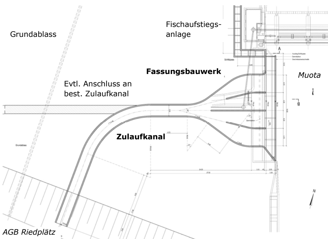
Abbildung 4-1 Situation des geplanten Fassungsbauwerks und Zulaufkanals.
