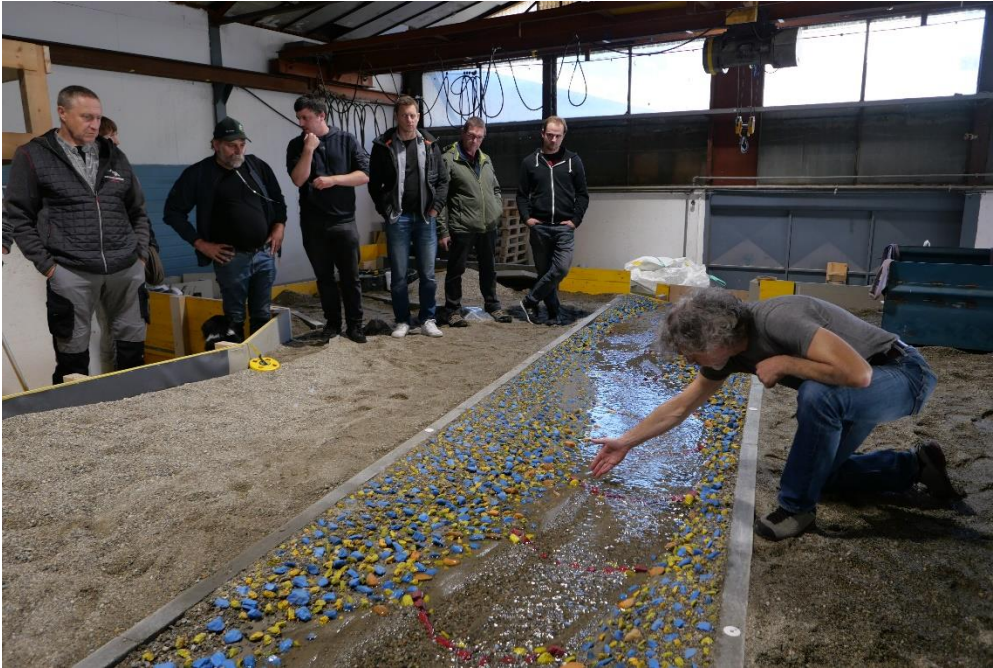
Abbildung 1: Christian Tognacca (Laboratorium 3D, Wasserbauingenieur) stellt das Modell (Massstab 1:30) der Sihl vor
