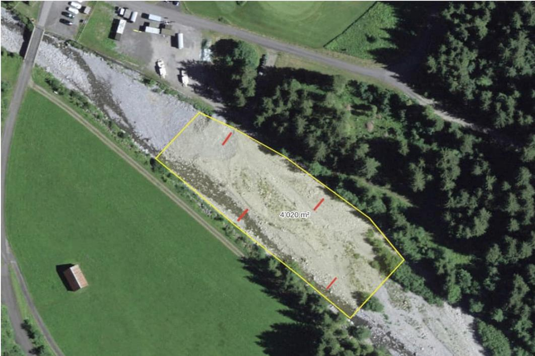
Abbildung 12: Mögliche Anordnung der Einzelrechen im Abschnitt Schwyzer Blätz
