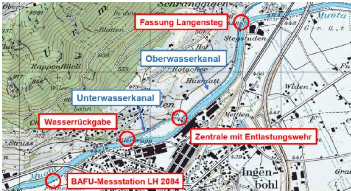
Abbildung 8: Situationsübersicht des Kleinwasserkraftwerkes Brunnen, ergänzte Abbildung aus [22]
