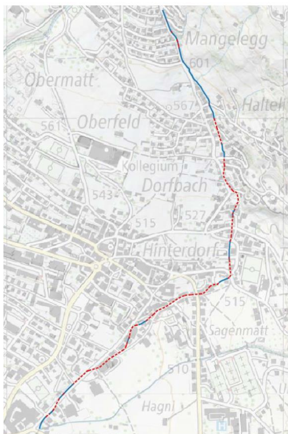
Abbildung 2: Projektperimeter, blaue Abschnitte zeigen offenes Bachgerinne, rot-gepunktet bedeuten eingedolte Abschnitte.
